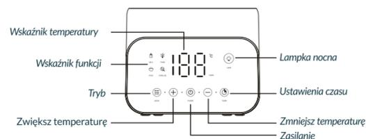
Wyświetlacz jest wyposażony w sześć przycisków: „zasilanie”; „tryb”; „przycisk zwiększenia temperatury”; „przycisk zmniejszenia temperatury”; „ustawienia czasu” i „lampa nocna”.
